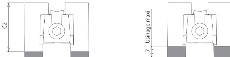
**4** Usiner les flancs de notre chariot à la cote C3 (avant l'assemblage des différents composants, le chariot devra être exempt de tout copeaux dues aux différents usinages).
