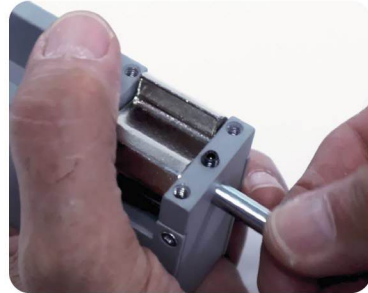
2.4 - Remettre l'axes a sa place et visser.
