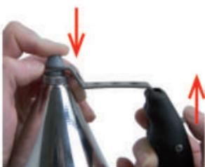
2. Empujar la boquilla hacia abajo y posicionarla con el botón de bloqueo y empujar hacia.
