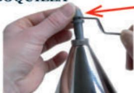
1. Introducir la barra perforada en la ranura de la boquilla.
