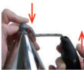
2. Die Düse nach unten drücken und mit dem Feststellhebel durch Drücken nach oben verriegeln.
