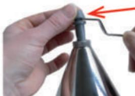
1. Den Bügel in die Düsenkerbe einsetzen.
