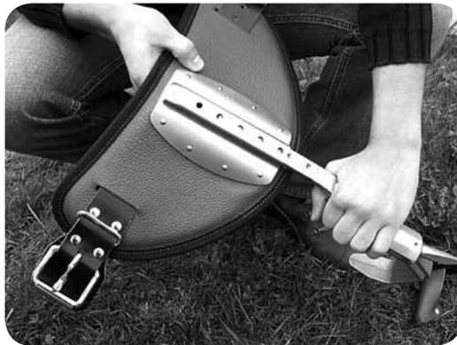
Insérer l'équerre dans le fourreau métallique du coussinet protecteur.
