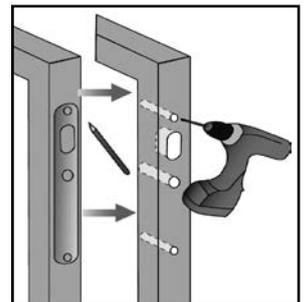
**7.** Positionner la gâche et la fixer à l'aide des vis 4,8x45 et des plots.
