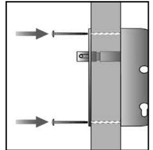
**6.** Côté gâche, repérer l'empla-cement des perçages et percer 3 trous Ø10 traversants pour les vis et 1 trou non traversant pour le pêne.
