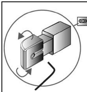
**4.** Positionner la vis 5x20 dans le trou intermédiaire de la têteière et serrer l'écrou.
