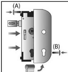
**3.** En fonction de la configuration, choisir le sens du pêne réversible et le bloquer à l'aide de la vis pointeau.
