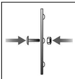
**5.** Placer la têteière sur le devant du tube et positionner la serrure en passant le pêne au travers du tube puis visser têteière et serrure ensemble avec les 2 vis 4,8x70.
